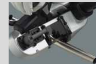
Bandgeschwindigkeit 1 (langsam) Für rostfreien Stahl usw.*2
