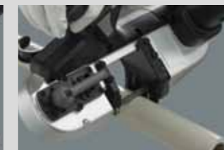
Bandgeschwindigkeit 2 (mittel) Für Ablaufrohre von Klimaanlage usw.*2
