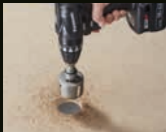
Perçage vertical dans les panneaux de bois
